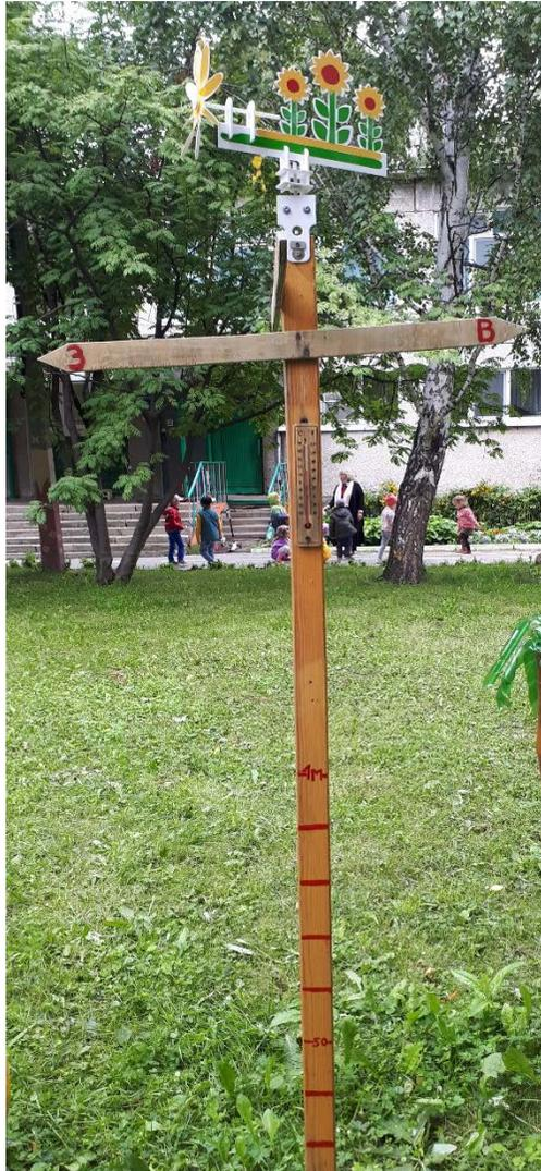
Прибор для определения направления ветра, температуры и высоты снежного покрова
